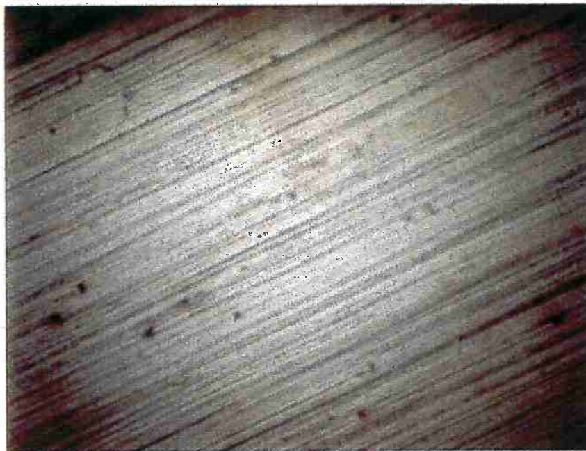
Figura 5.9 - Aspecto da superfície do eletrodo de zinco in situ na solução K_2SO_4 0,1M de pH 11 com EDTA. Potencial = 1,0 V. 80x.
