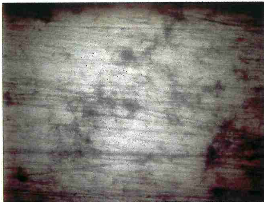
Figura 5.8 - Aspecto da superfície do eletrodo de zinco in situ na solução K_2SO_4 0,1M de pH 11 sem EDTA. Potencial = 1,0 V. 80x.
